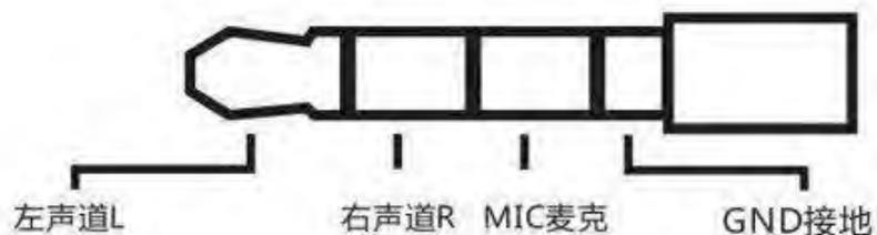
图7. IDO-EVB3568-V1国标耳机示意图
