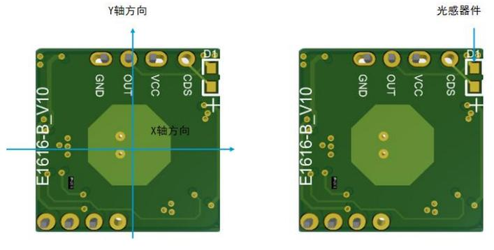
图 5 感知方向和光感器件
